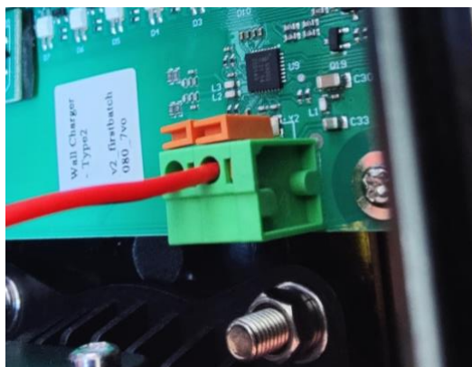
Figure 1 – Connexion de la pince à l'aide des connecteurs à ressort
